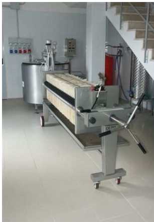
Il filtro-pressa ed i serbatoi di fermentazione
